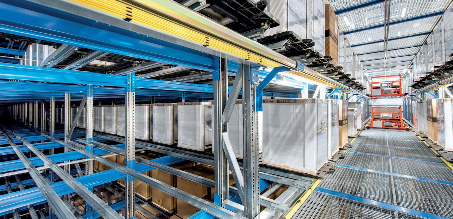
Maximale Kompaktheit: Bis zu 43 Elektrogroßgeräte können in einem Kanal hintereinander gelagert werden.
