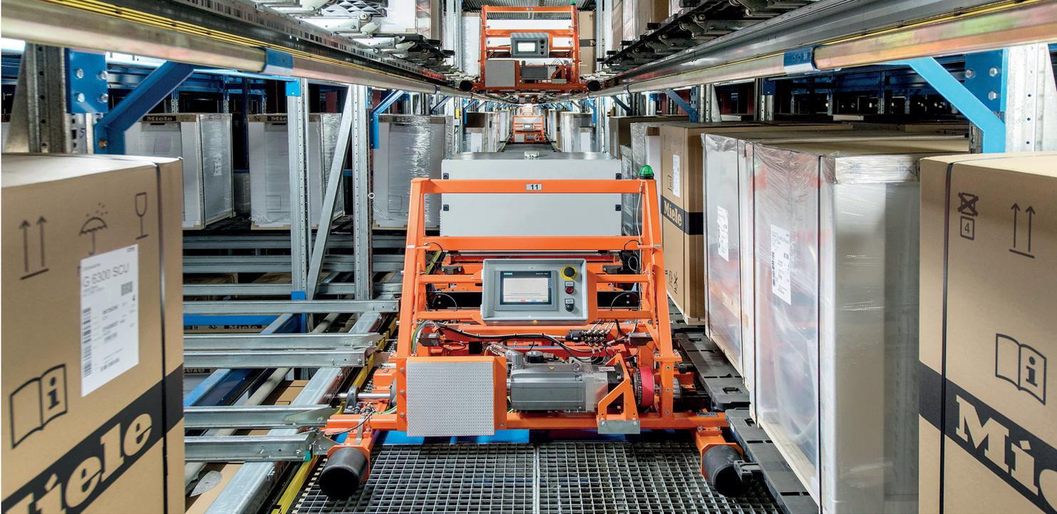
Miele-Unikat Trolley: Jedes Verteilfahrzeug legt 120 km pro Tag zurück. 8 Sekunden braucht es für eine Ein- oder Auslagerung.
